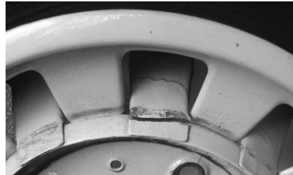
Nicht zu sehen, da der Riss unter der Radkappe liegt.
