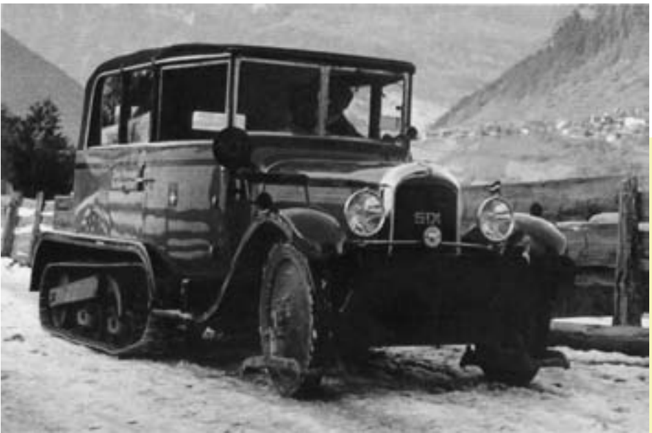
Citroën Kegresse Typ P15N mit C6-Motor: Unterwegs auf der Poststrecke Chur - Tschierschen
