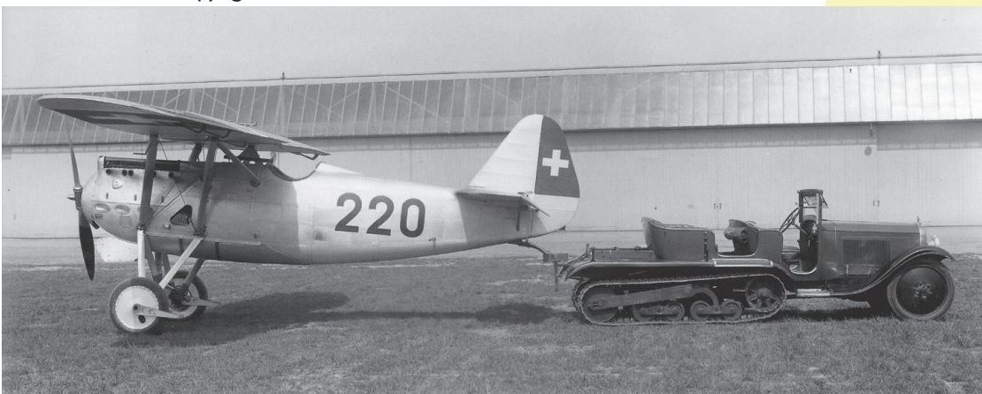
Ein Citroën Kégresse Halbkettenfahrzeug zieht hier eine Dewoitine D.27 III
