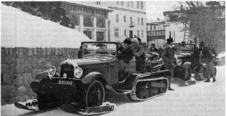
Zwei Autochenilles vor dem Kulm Hotel. Mit ihnen wurde nun auch die Anreise über den verschneiten Julierpass komfortabler.
