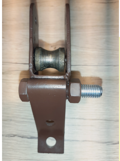
M12 x 60 Schraube in Winkel eingeschweisst Ansicht von oben
