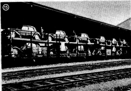
15 Rationeller Autotransport aus Frankreich für die Schweiz in doppelstöckigen Eisenbahngüterwagen von etwa 14 m Länge. Ankunft in Basel.
