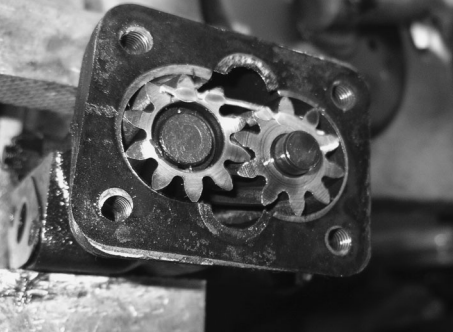
Die offenen Zahnräder der Ölpumpe
