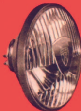
OPTIQUES au Code européen pour la trans- formation des projecteurs américains
