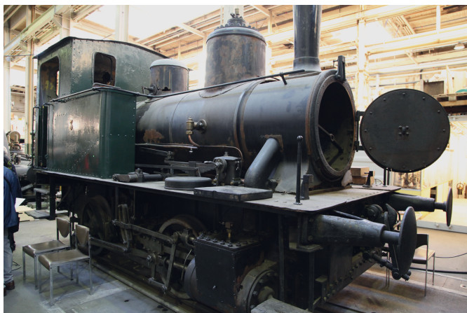
links: Dampflokomotive E2/2 der SLM Winterthur. Sulzer Werkslokomotive 1907 - 1971, 50 PS
