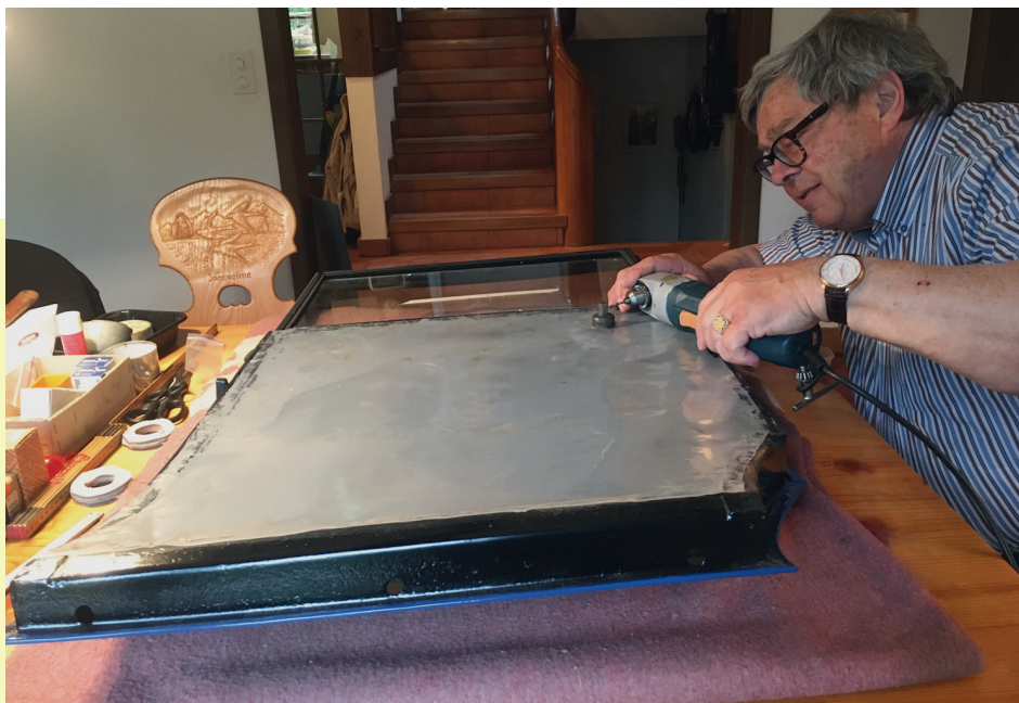
Bohren für den Halte-Stift der Fenster-Kurbel
