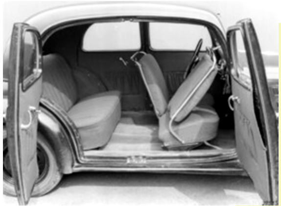
Mercedes-Benz 130 VB (1936) Neues Raumkonzept mit grosszügigem Einstieg ohne B-Säule und mit flachem Boden
