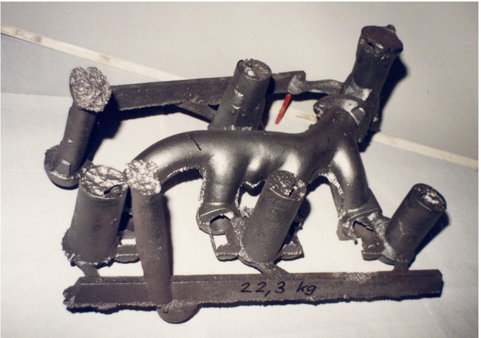
Komplette Gusstraube mit Abgaskrümmer, Eingusskanälen, Läufen, Anschnitten mit Saugern, Steiger. Gewicht 22,3 kg
