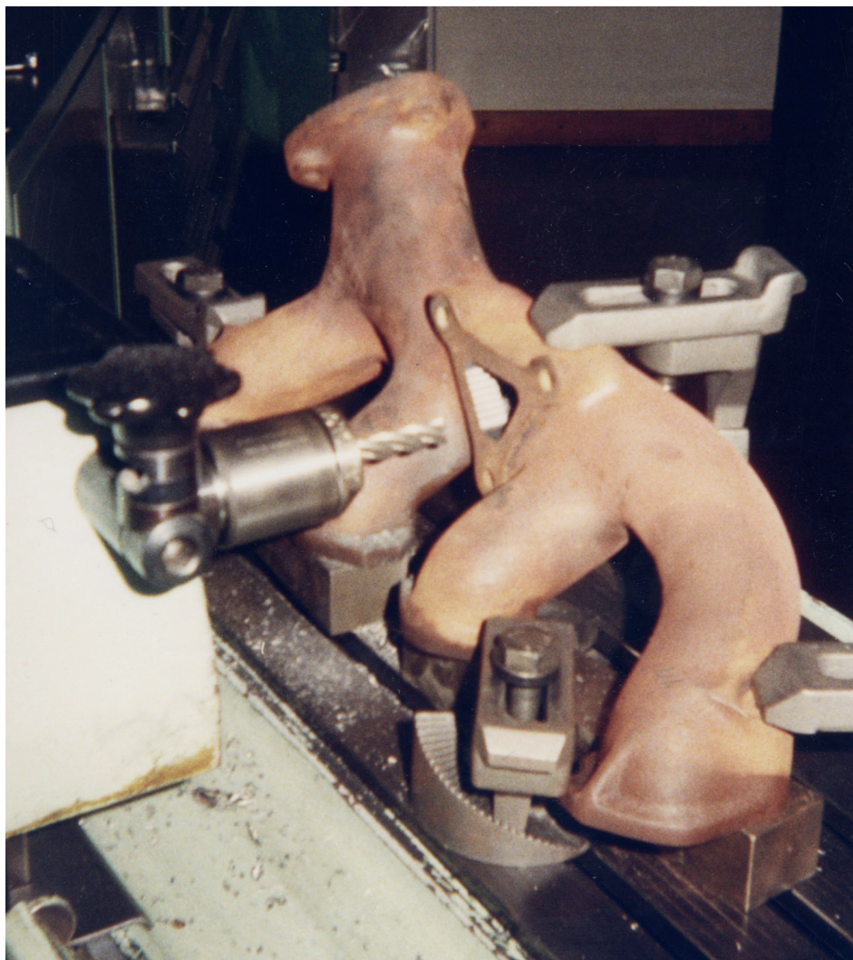
Herausfräsen der dreieckigen Gemisch-Vorwärmeöffnung
