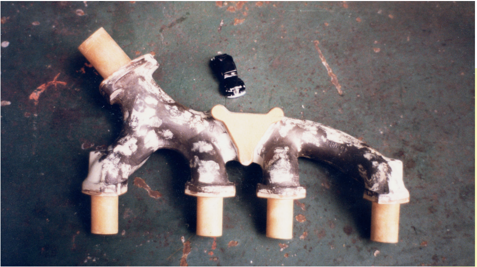
Modell aus originalem gerissenen GG-Krümmen, Unebenheiten geglättet, mit 5 Kernlagerzapfen
