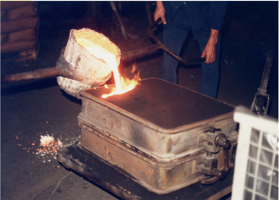
Handabguss mit GGG SiMo 51 , 5% Silizium, 1% Molybdän
