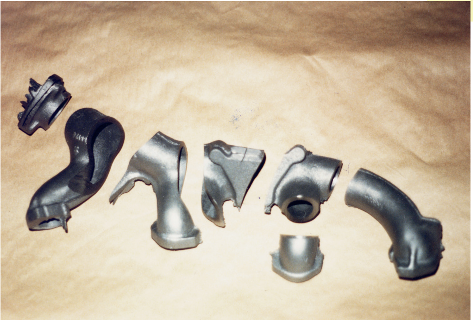
Erstes Abgussmuster, zersägt zur Dichtheits- und Wandstärkenkontrolle
