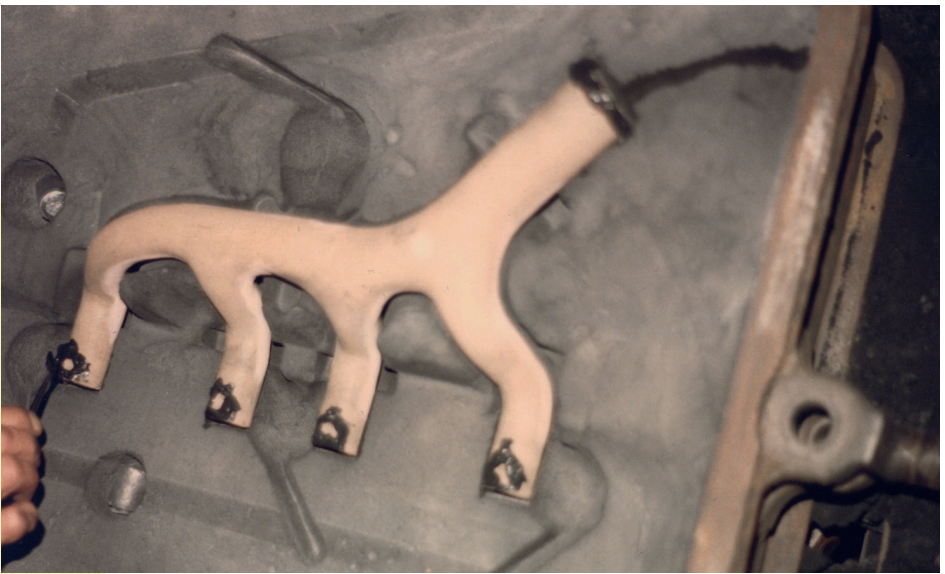
Form-Unterteil mit eingelegtem Kern, Gas-Austrittslöcher abgedichtet
