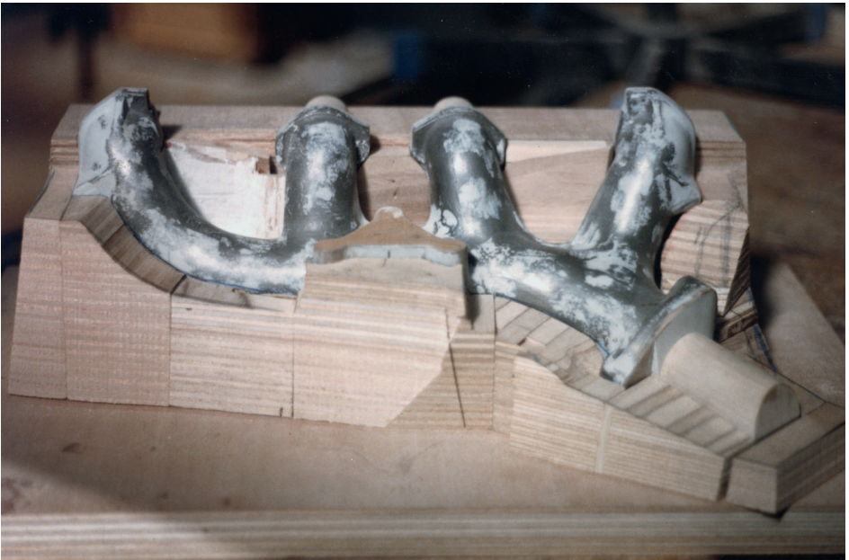
Scheidungsklotz (definiert die Formteilung, Lehlingsarbeit) im Rohbau, mit Modell
