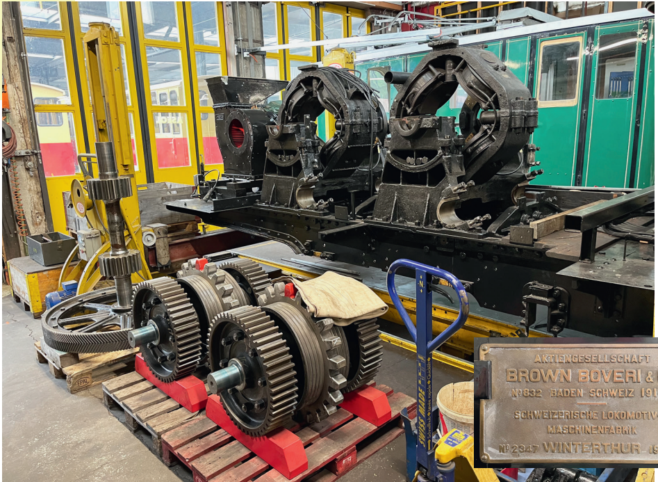
Daneben liegt die zerlegte elektrische Lokomotive Nr. 12 von 1914. Vorn in der Mitte die beiden Zahnräder des Antriebs. Die normalen Räder auf den Schienen laufen beim Fahren einfach mit, ohne selbst angetrieben zu sein. Dahinter steht das Chassis mit den beiden Statorn der Elektromotoren für den Antrieb und im Hintergrund das grüne Gehäuse der Lokomotive.
