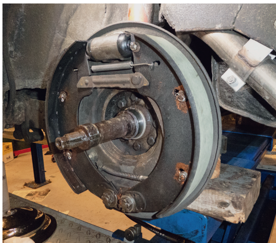
Aufvulkanisierter weicherer (grüner) Bremsbelag
