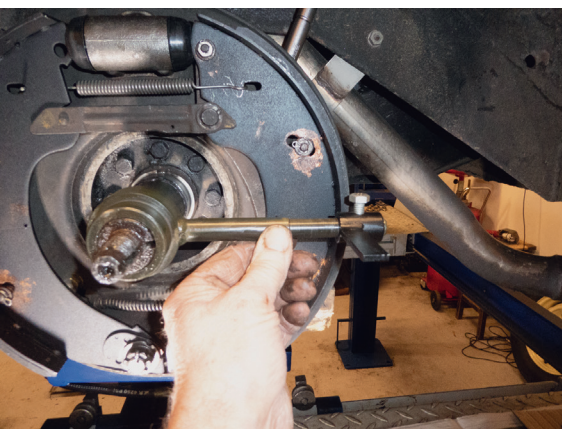
Bremslehre entlang des Bremsbelags bewegen
