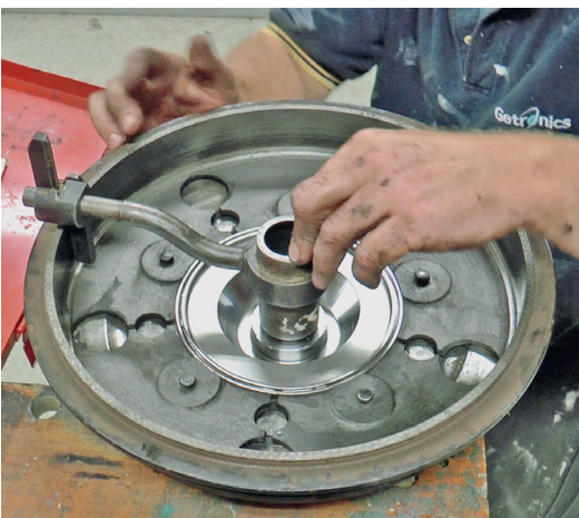
Innenmasse der Trommel abnehmen.
