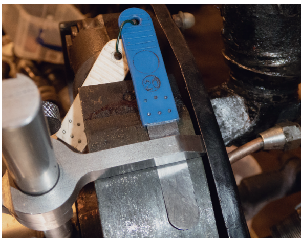
Fühlerlehre (0,20mm) zwischen Bremslehre und Bremsbelag einlegen.
