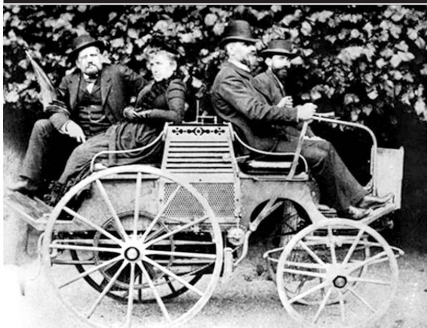
Prototyp von Panhard & Levassor mit Mittelmotor und Hinterradantrieb, 1890/91. Hinten sitzen René Panhard und Louise Levassor, vorne Émile Levassor und der Werkstattdirektor Émile Mayade.
