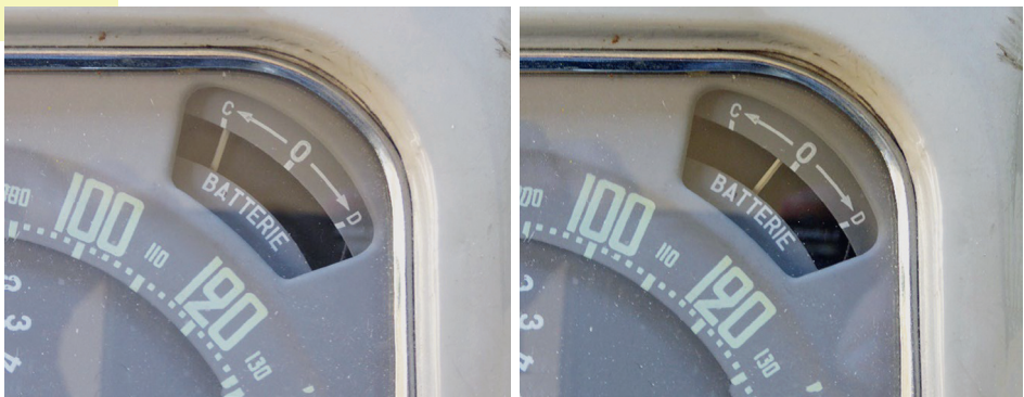
Hoher Ladestrom zur Batterie (nach dem Starten des Motors)
