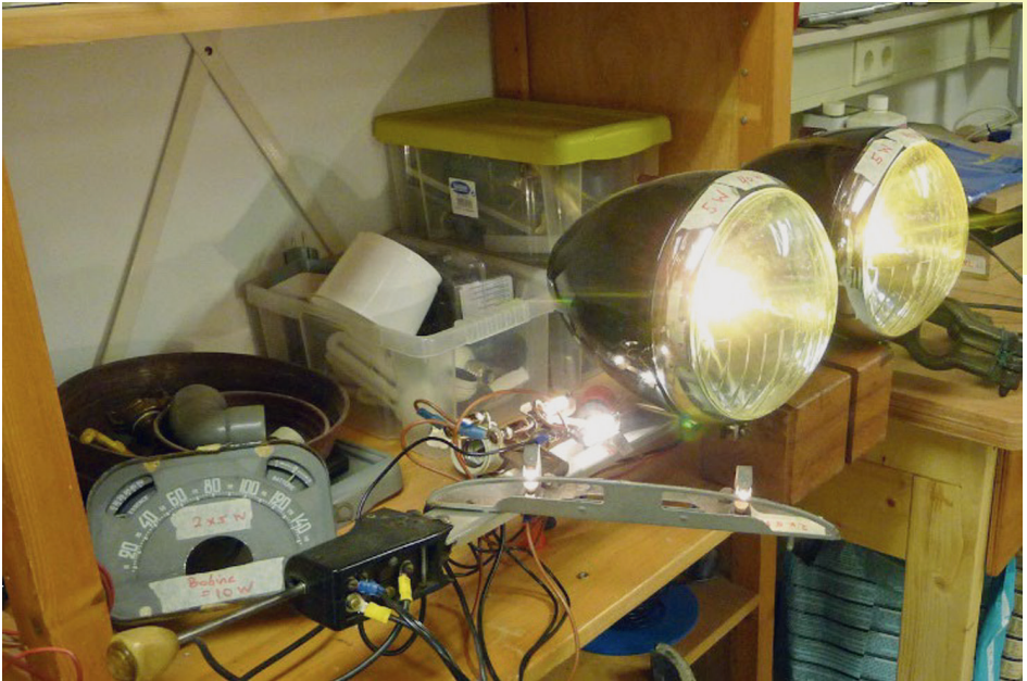
Elektrische Last mittels Lampen realisiert
