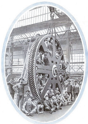
Boue cylindrique en 3 pièces pour Treuil électrique de Mines. Diamètre extérieur : 5 mètres. — Poids : 29 tonnes.
