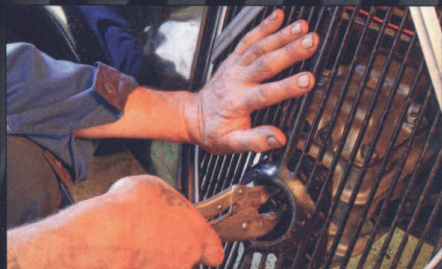
Packt man die Aufnahme für die Anlasserkurbel und bemerkt deutliches Axialspiel , sind womöglich die Getriebewellenlager verschlissen
