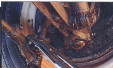
Check der Konusverbindung des Lenkhebels . Hat der Hebel Spiel, kann der als Sicherung gedachte kleine Keil brechen – die Lenkung klemmt
