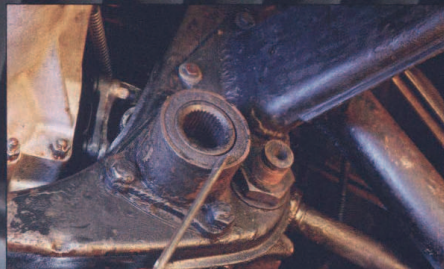
Der große Spalt mahnt zum Erneuern der vorderen Silentbuchsen – eine teure Reparatur, weil die Nutenwellen herauszupressen sind
