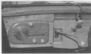
Edler: In England waren Holz und Leder Standard, in Paris gebaute Roadster waren spartanscher ausgestattet. Mit dem Rändelrad lässt sich die Windschutzscheibe unten einen Spalt weit öffnen.
