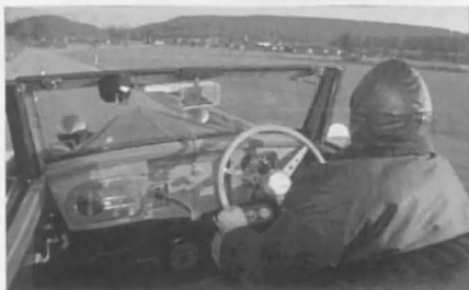
Edler: In England waren Holz und Leder Standard, in Paris gebaute Roadster waren spartanscher ausgestattet. Mit dem Rändelrad lässt sich die Windschutzscheibe unten einen Spalt weit öffnen.
