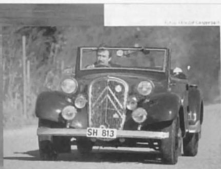
Britische Eigenart: gerade Stosstange – französische Versionen hatten sie erst nach dem Krieg. Zeitgenössisch: Zusatzleuchten und -hörner.
