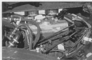
Teure Entwicklung: Der Vierzylinder mit den hängenden Ventilen war eine teure Neuentwicklung, hier mit 1,9 Liter Hubraum (31 CV) und respektablen 54 PS.
