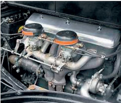
Ein Blick unter die Haube. Die Weiterentwicklung des Vierzylinders war der Sechszylinder-Motor mit zwei Vergasern.
