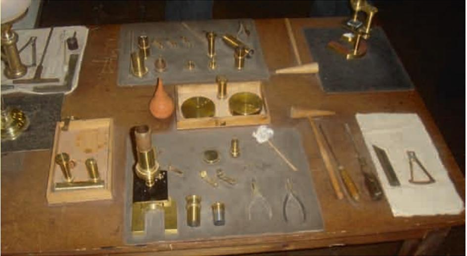
Nebst den Gläsern wurden auch die nötigen Fassungen aus Messing mit ebenso hand- und fussbetriebenen Scheren und Drehbänken hergestellt. Durch das Weiterentwickeln der Linsen, jetzt mittels Glasschmelzverfahren hergestellt und dem Präbeln mit lichtempfindlichen Substanzen, entstanden in Jena Jahre später die ersten „Photoapparate“.
